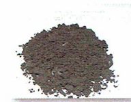
Abb. 1: Energiefreie Schlamm-trocknung für kleine Kläranlagen
