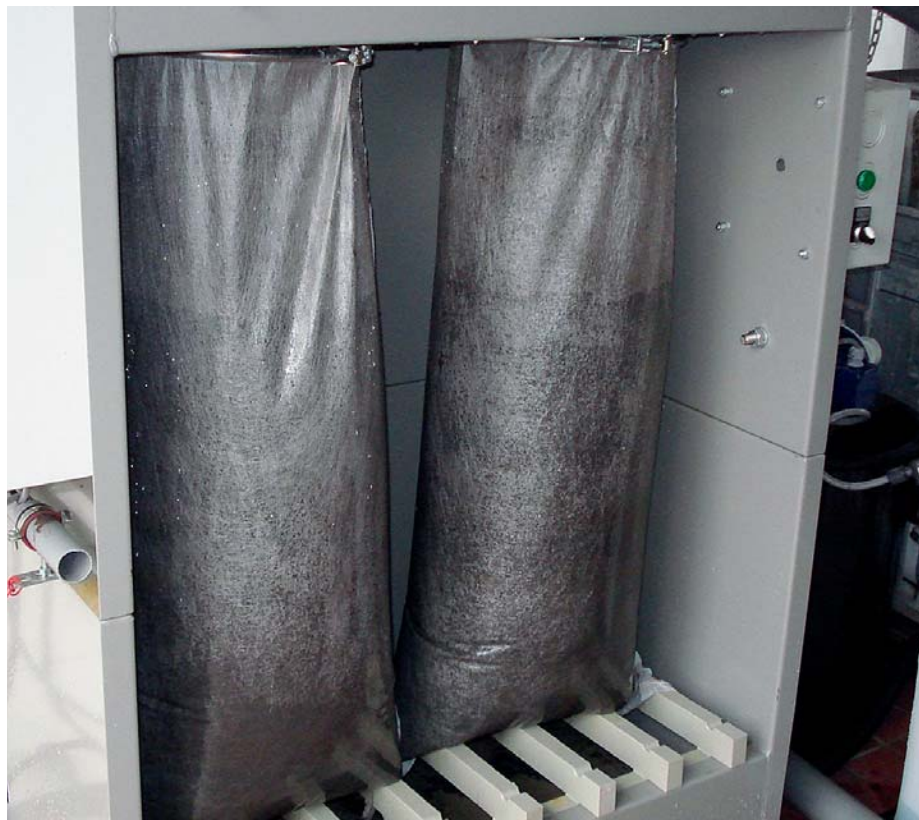
Probetrieb der Filtersack entwässerung für die KA Werther mit einem stationären, rechteckigen Entwässerungsgestell für zwei Filtersäcke Bild 1
