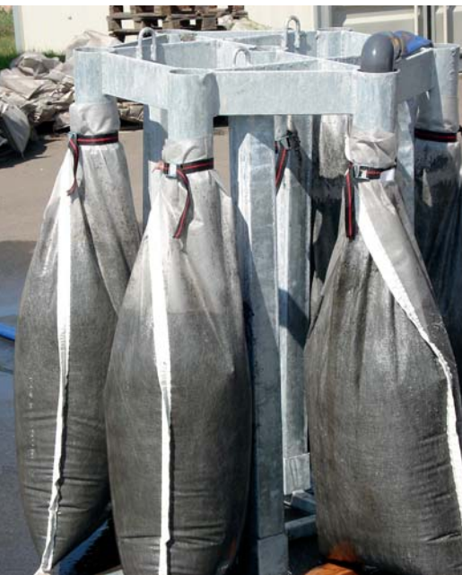
Mit Schlamm gefüllte Filtersäcke am Gestelloberteil – Einzelbefüllung der Säcke Bild 3
