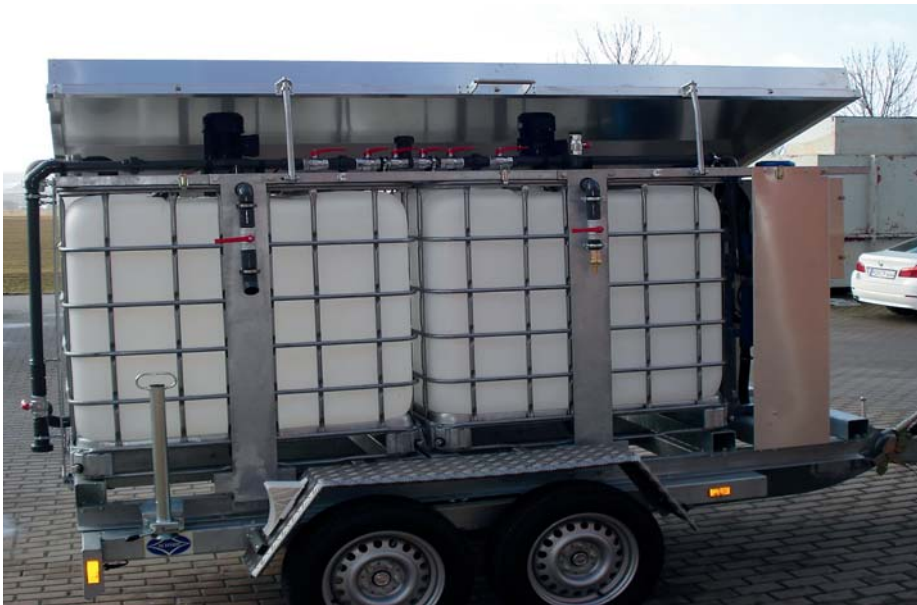
Mobile Anlage zur Konditionierung des aerob stabilisierten Schlammes
